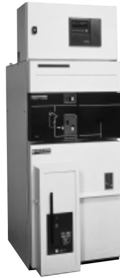
Abb. 4: Ein Beispiel für die Anwendung der EMV: Eine MS-Zelle «SM6» enthält einen Leistungsschalter, der Hunderte von Ampere unter mehreren zehn Kilovolt unterbrechen kann, sowie eine programmierbare Schutz- und Steuereinheit SEPAM. Das Ganze muss jederzeit absolut betriebsbereit sein.
